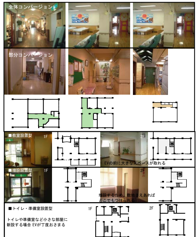
図2 動線部分の改修設計手法
