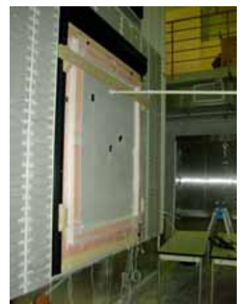
写真10 断熱実験状況
