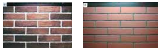
写真1 パネル試料例(左:白目地, 右:灰色目地)
